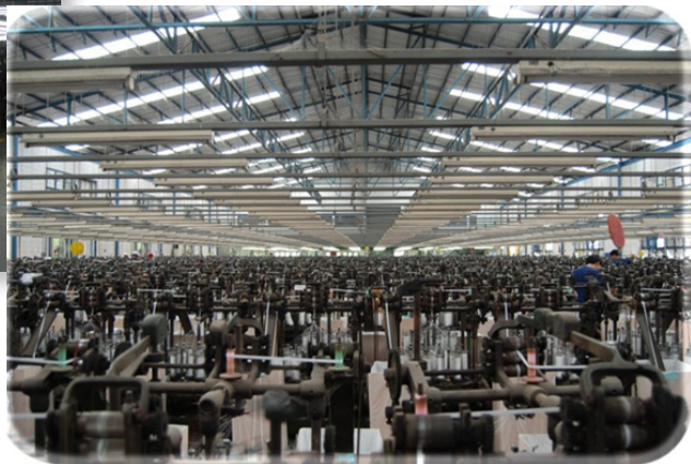
หลังเปลี่ยนเป็นกระเบื้องเมทัลชีท และแผ่น โปร่งแสงกัน UV ไม่ต้องเปิดไฟในช่วงกลางวัน
