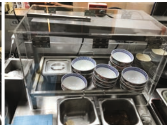
ตู้กระจกและหลอดให้ความร้อนเครื่อง Heat Lamp Warmer
