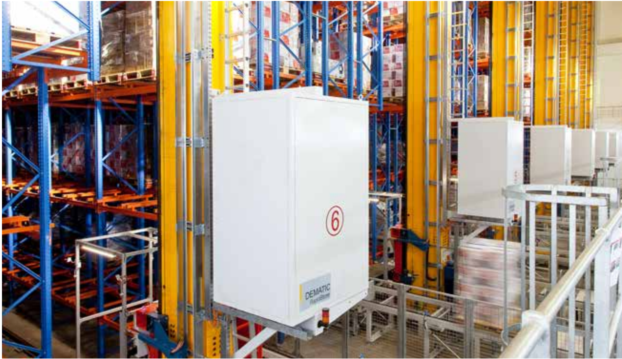
ศูนย์กระจายสินค้าที่อำเภอเมือง จังหวัดสมุทรสาคร ใช้ระบบคอมพิวเตอร์ ASRS ควบคุมการจัดเก็บสินค้าแข่ง
