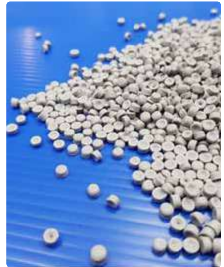
เม็ดพลาสติกโพลีเอทิลีนความหนาแน่นสูงเกรดพิเศษ (High Density Polyethylene: HDPE) เพื่อใช้เป็น ก้อนลอยน้ำสำหรับแผงพลังงานแสงอาทิตย์
