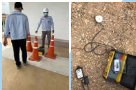
ภาพ : การตรวจวัดความสั่นสะเทือน
