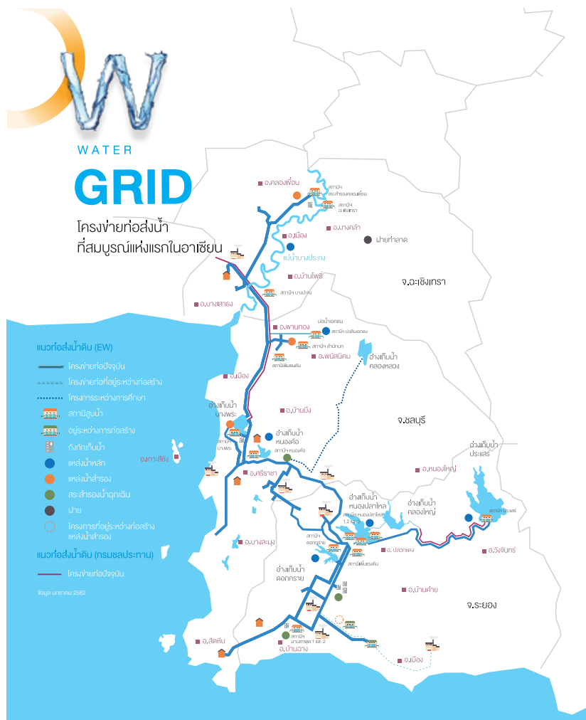
แผนภาพที่ 2 แผนที่แสดงระบบโครงข่ายท่อส่งน้ำในจังหวัดระยอง ชลบุรี และฉะเชิงเทรา
