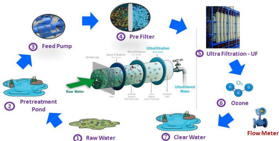
กระบวนการบำบัดน้ำด้วยระบบอัลตราฟิเตรชัน (Ultrafiltration) และกำจัดเชื้อด้วยระบบโอโซน (Ozone)
