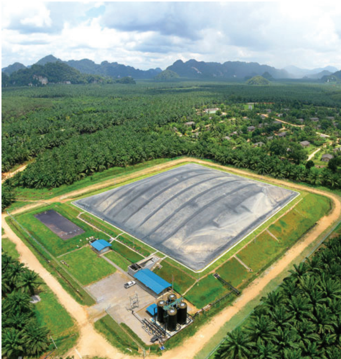
The Topy digester captures methane biogas to reduce greenhouse gas emissions from waste water บ่อหมักก๊าซมีเทนที่โรงงานไทยอุตสาหกรรมเพื่อลดการปล่อยก๊าซเรือนกระจกจากน้ำเสีย
