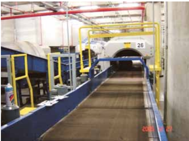
การตรวจค้นด้วยระบบ In-line Screening และเครื่อง CTX
