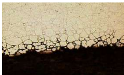
สนิมที่เกิดขึ้นกับผิวของหลังคาเหล็ก
