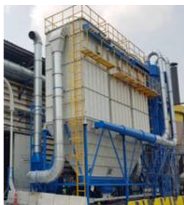
ดูดฝุ่นจากการแปรรูปในสายการผลิต และเป่าฝุ่นส่งผ่านระบบท่อไปเข้า SILO
