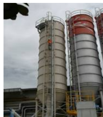
นำฝุ่นจากการแปรรูปเข้า SILO ไปใช้ในกระบวนการผลิต NT
