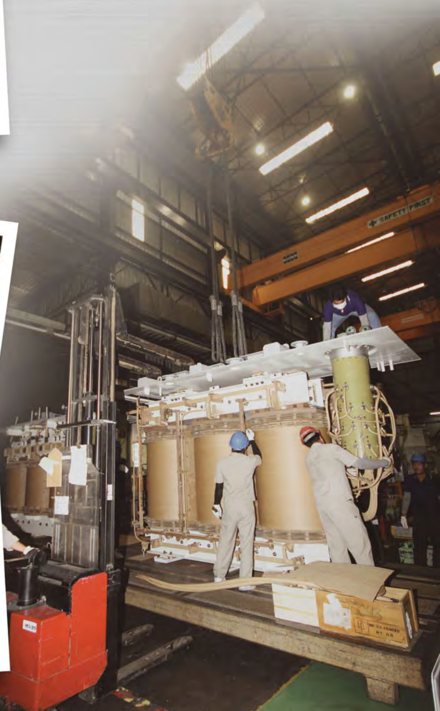
รูปแสดงลักษณะของหม้อแปลงระบบจำหน่ายแบบน้ำมัน
