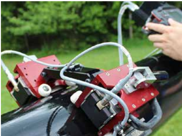
การทดสอบโดยคลื่นความถี่สูงแบบระยะทดสอบปานกลาง (Medium Range Ultrasonic Test)
