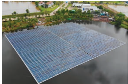
ภาพแสดงโครงการโรงไฟฟ้าพลังงานแสงอาทิตย์แบบติดตั้งบนน้ำ บริษัท ปราจีนบุรีกลาส อินดัสทรี จำกัด ขนาด 696.80 กิโลวัตต์
