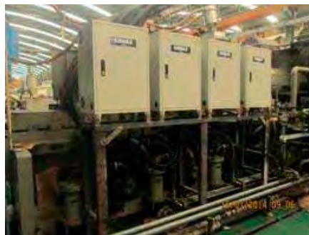
• ตู้คอนโทรล servo motor
