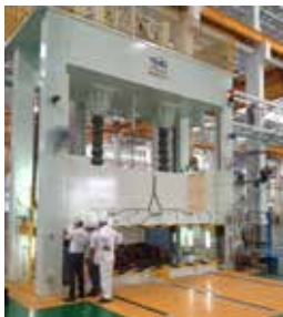
Hydraulic die spotting press (HDS)
