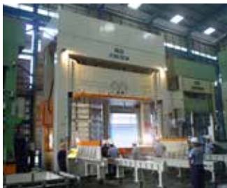
Hydraulic clapper die spotting press (HCD)
