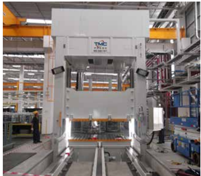
Hydraulic die spotting press (HDS)
