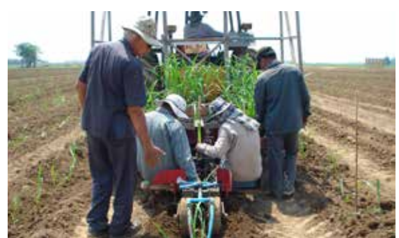
การสาธิตเครื่องปลูกอ้อยแบบ Shute Planter
