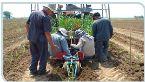
เครื่องปลูกอ้อยแบบ Shute Planter
