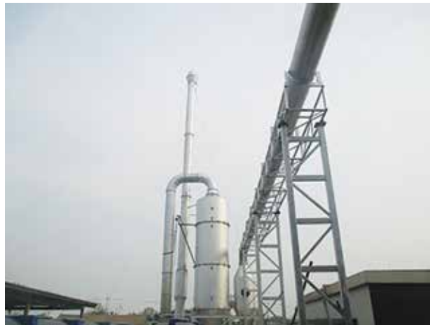
โครงการติดตั้งระบบบำบัดอากาศ Wet Scrubber ติดตั้งที่บริษัท พี.ซี.เอส.พีริซัน เวิร์ค จำกัด
