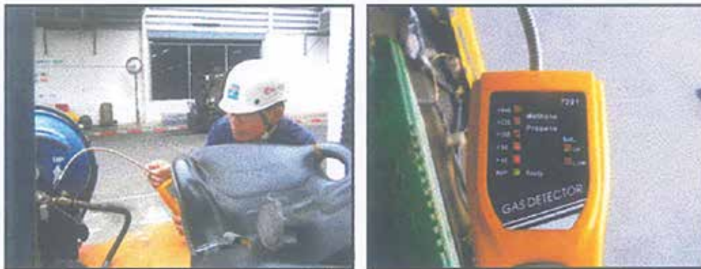
การตรวจสภาพการทำงานอุปกรณ์และส่วนควบคุมของระบบก๊าซ สกโฟร์คลิฟ
