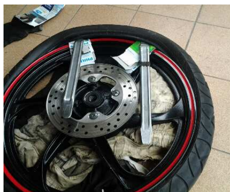
รูปที่ 4 : การประกอบยางนอก ชนิด Tubeless กับกระทะล้อ
