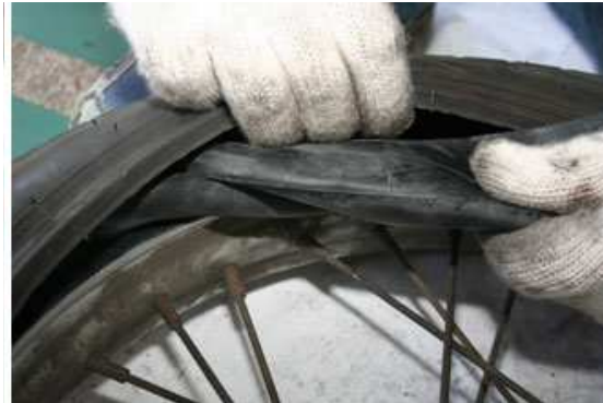
รูปที่ 3 : การประกอบยางนอก ชนิด Tube type กับกระทะล้อ
