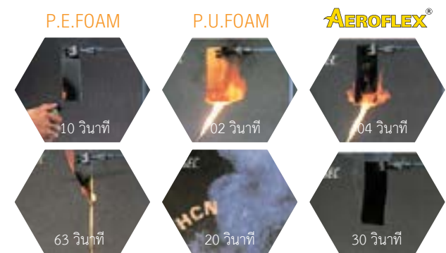
ภาพแสดงการทดสอบการเผาไหม้วัสดุประเภท Polyethylene Foam/ Polyurethane Foam และ ฉนวนยางแอร์โรฟลักซ์ที่ผลิตจากสารตั้งต้น EPDM
