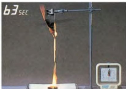
ภาพแสดงการทดสอบการเผาไหม้วัสดุประเภท Polyethylene Foam/ Polyurethane Foam และ ฉนวนยางแอร์โรเฟล็กซ์ที่ผลิตจากสารตั้งต้น EPDM
