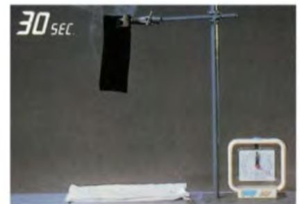
ภาพแสดงการทดสอบการเผาไหม้วัสดุประเภท Polyethylene Foam/ Polyurethane Foam และ ฉนวนยางแอร์โรเฟล็กซ์ที่ผลิตจากสารตั้งต้น EPDM
