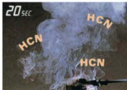
ภาพแสดงการทดสอบการเผาไหม้วัสดุประเภท Polyethylene Foam/ Polyurethane Foam และ ฉนวนยางแอร์โรเฟล็กซ์ที่ผลิตจากสารตั้งต้น EPDM
