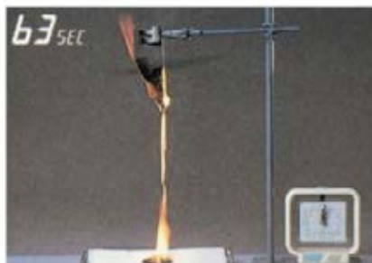
ภาพแสดงการทดสอบการเผาไหม้วัสดุประเภท Polyethylene Foam/ Polyurethane Foam และ ฉนวนยางแอโรฟเลกซ์ที่ผลิตจากสารตั้งต้น EPDM
