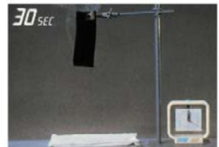
ภาพแสดงการทดสอบการเผาไหม้วัสดุประเภท Polyethylene Foam/ Polyurethane Foam และ ฉนวนยางแอโรฟเลกซ์ที่ผลิตจากสารตั้งต้น EPDM
