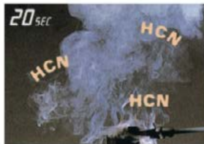
ภาพแสดงการทดสอบการเผาไหม้วัสดุประเภท Polyethylene Foam/ Polyurethane Foam และ ฉนวนยางแอโรฟเลกซ์ที่ผลิตจากสารตั้งต้น EPDM
