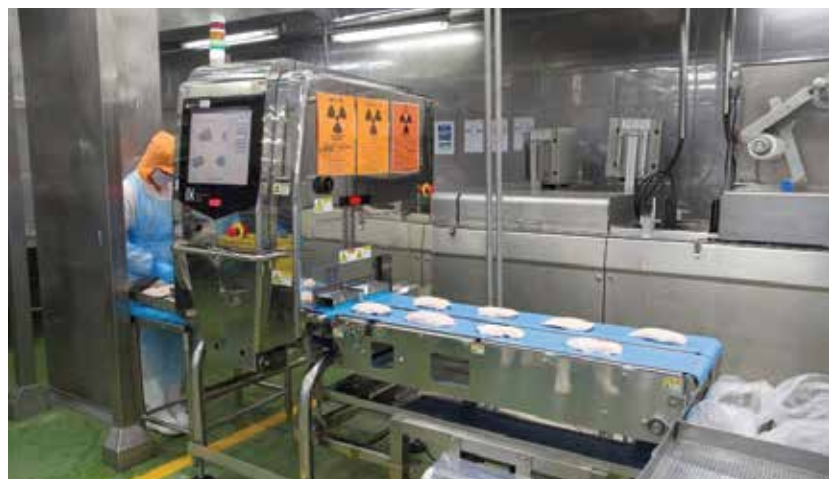
เครื่อง X-Ray ตรวจสอบเนื้อเป็ดหลังผ่านกระบวนการตัดแต่ง
