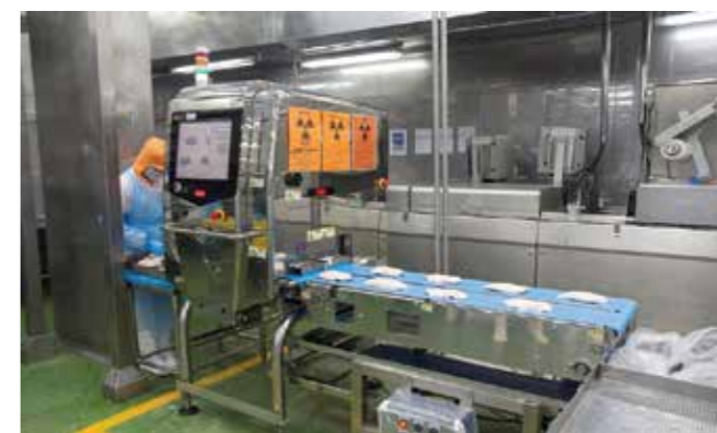
เครื่อง X-Ray เฝ้าระวังในเนื้อเป็ดหลังผ่านกระบวนการตัดแต่ง
