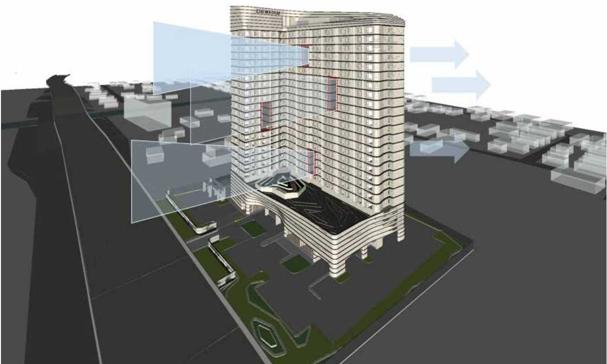
ภาพแสดงรูปทรงและทิศทางของลม ที่ไหลเข้าสู่ตัวอาคาร (โครงการชีวกาย เกษตร-นวมินทร์)
