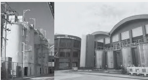
วัตถุดิบชนิดผงและชนิดเหลวถูกเก็บไว้ใน SILO และ Storage tank
