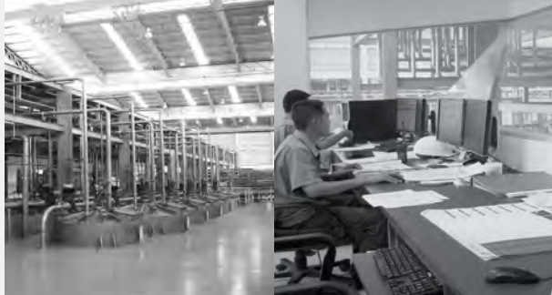
การส่งผ่านวัตถุดิบไปทำการผลิต โดยผ่านระบบท่อ ควบคุมด้วยระบบอัตโนมัติ
