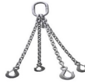
ตัวอย่างโซ่ (Chain) แสดงภาพการใช้งานโซ่ 4 ขา ที่มีการ ประกอบเข้าชุดกับ Master Link (ปลายด้านบน) และตะขอ (ปลายด้านล่าง) พร้อมใช้งาน
