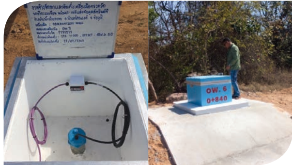
ภาพตัวอย่าง : เครื่องมือ Observation Wall
