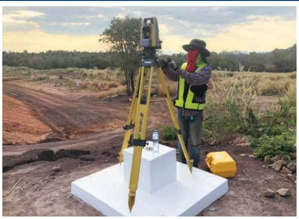
เครื่องมือ Survey for Reference Benchmark
