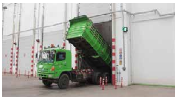
การนำขยะเข้าสู่เตาเผาไหม้ โดยเป็นระบบปิดของโรงไฟฟ้า MSW ขอนแก่น (อำเภอเมือง จังหวัดขอนแก่น)
