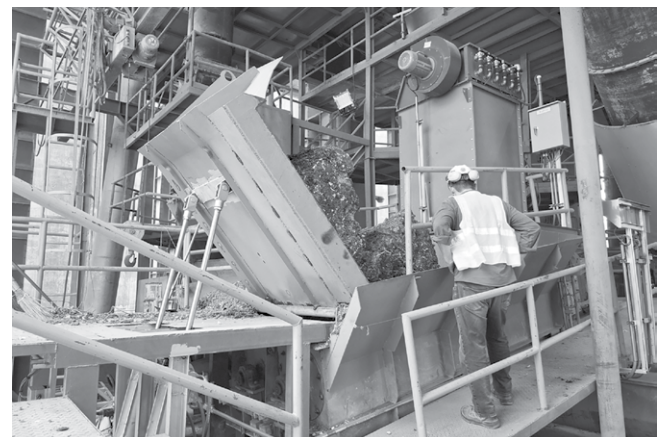
รูป: ระบบการป้อนเชื้อเพลิงชีวมวล ในเตาเผาที่ 6
