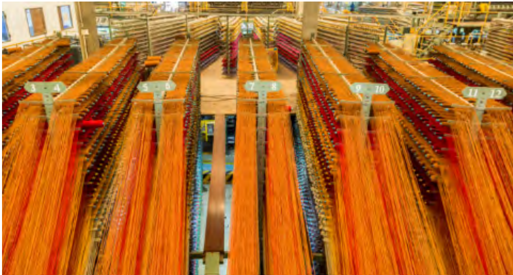
ภาพแสดงการ Yarn on creel สำหรับการทอพรม Woven Axminster Carpet
