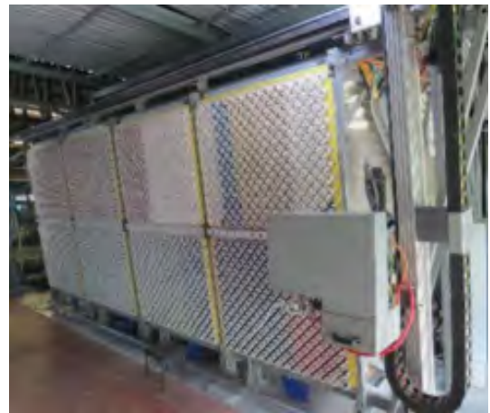
ภาพแสดงการ Yarn on creel สำหรับการทอพรม Woven Axminster Carpet
