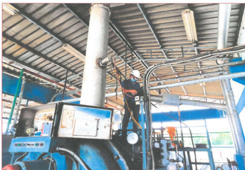
รูปที่ 1 การตรวจวัด Total Suspended Particulate (TSP), Sulfur dioxide ( \text{SO}_2 ), Carbon monoxide (CO) และ Oxides of Nitrogen as Nitrogen dioxide ( \text{NO}_2 ) บริเวณปล่อง Boiler
