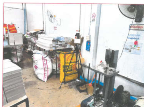
รูปที่ 4 การตรวจวัด Total Dust บริเวณ เครื่องตัดกระดาษ
