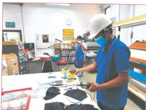
รูปที่ 17 การตรวจวัดแสงสว่าง (Light level) บริเวณ พื้นที่ทำงาน
