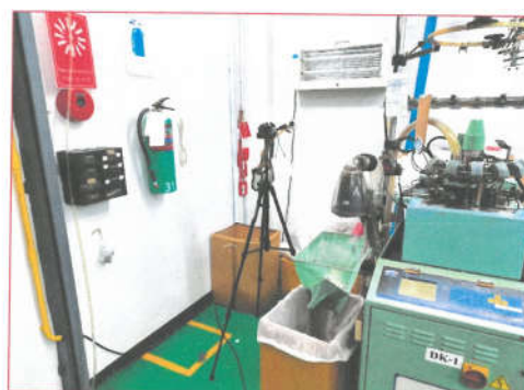
รูปที่ 6 การตรวจวัด Total Dust บริเวณ แผนกติดตั้งห้องเล็ก
