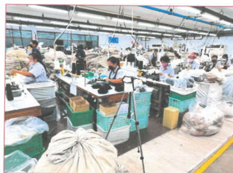
รูปที่ 8 การตรวจวัดระดับเสียงเฉลี่ย 8 ชั่วโมง บริเวณ over lock จักรเย็บผ้า
