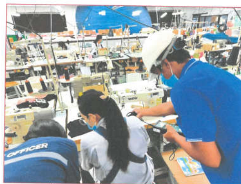
รูปที่ 16 การตรวจวัดแสงสว่าง (Light level) บริเวณ พื้นที่ทำงาน
