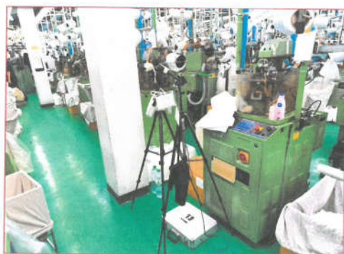
รูปที่ 5 การตรวจวัด Total Dust บริเวณ แผนกติดตั้ง Line 4
