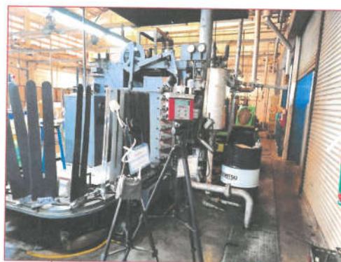
รูปที่ 20 การตรวจวัดระดับความร้อน (Heat Stress) บริเวณ เครื่องรีดตัว T : คุณจำเรียง
