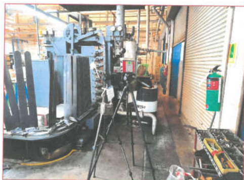
รูปที่ 3 การตรวจวัด Total Dust บริเวณ เครื่องรีด P
