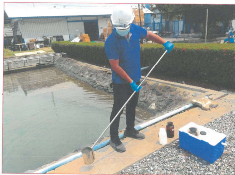
รูปที่ 21 การเก็บตัวอย่างน้ำทิ้ง จาก Inlet
