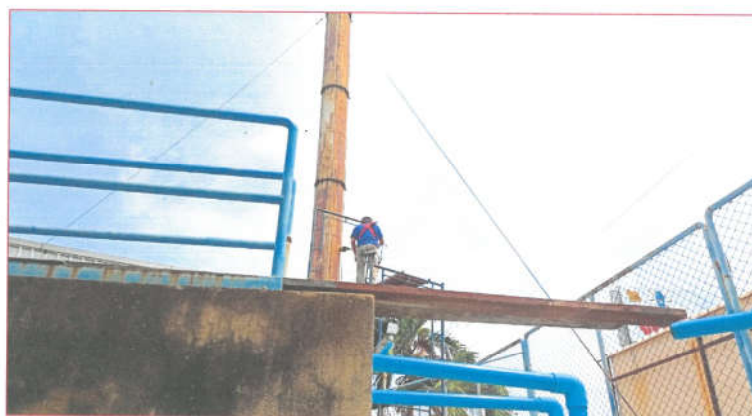
รูปที่ 1 การตรวจวัด Total Suspended Particulate (TSP), Sulfur dioxide ( \text{SO}_2 ), Carbon monoxide (CO) และ Oxides of Nitrogen as Nitrogen dioxide ( \text{NO}_2 ) บริเวณปล่อง Boiler
