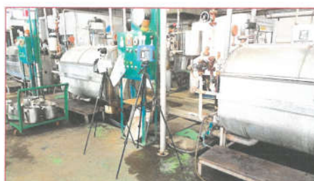
รูปที่ 7 การตรวจวัดระดับความร้อน (Heat Stress) บริเวณ เครื่องย้อม : คูณมนตรี
