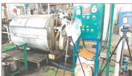
รูปที่ 5 การตรวจวัด Sodium hydrosulfite as Sodium, Acetic acid และ Formic acid บริเวณ เครื่องย้อม
