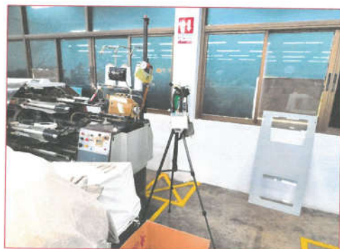
รูปที่ 7 การตรวจวัด Total Dust บริเวณ over lock เครื่องจักร TC2
