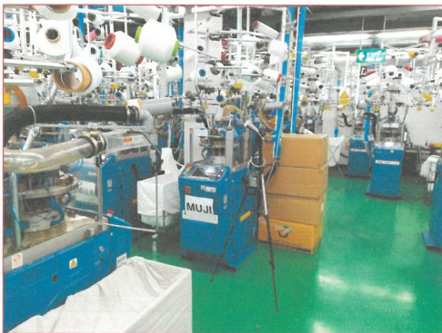
รูปที่ 5 การตรวจวัด Total Dust บริเวณ แผนกไนตติ้ง Line 3
