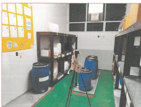
รูปที่ 14 การตรวจวัด Acetic acid และ Formic acid บริเวณ ห้องเก็บสารเคมี
