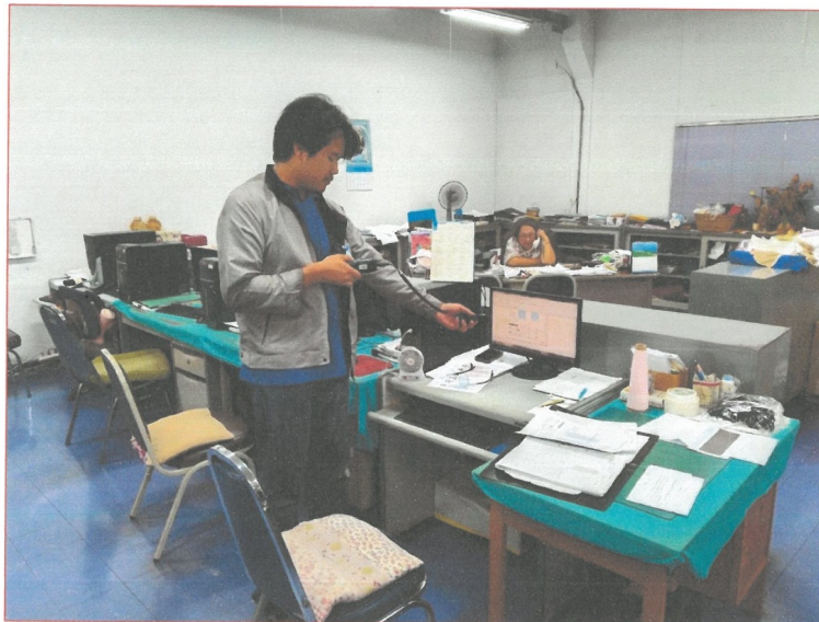
รูปที่ 21 การตรวจวัดแสงสว่าง (Light level) บริเวณ พื้นที่ทำงาน
