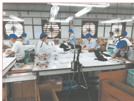
รูปที่ 10 การตรวจวัด Total Dust บริเวณ แผนก Packing
