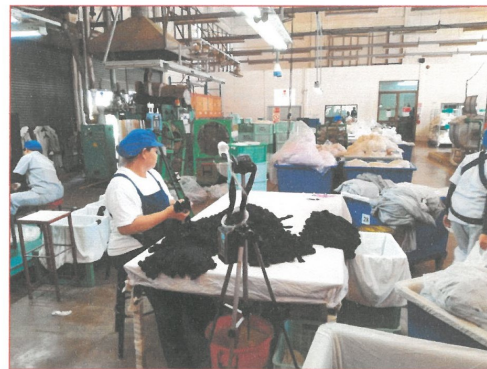
รูปที่ 4 การตรวจวัด Total Dust บริเวณ โต๊ะเรียงงานเครื่อง T
