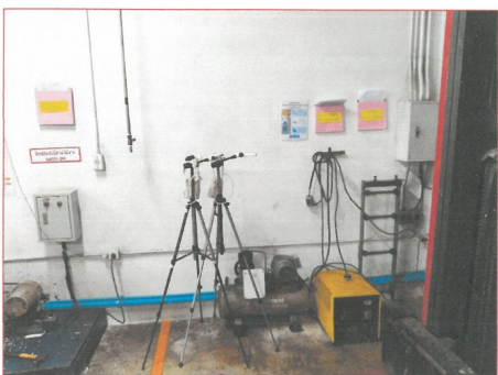
รูปที่ 13 การตรวจวัด H_2SO_4 และ Hydrogen sulfide บริเวณ พื้นที่ชาร์ทแบ็ตเตอร์รีดโฟลด์ลิฟท์
