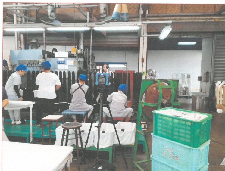
รูปที่ 22 การตรวจวัดระดับความร้อน (Heat Stress) บริเวณ เครื่องรีดตัว T : คุณศิริเพ็ญ
