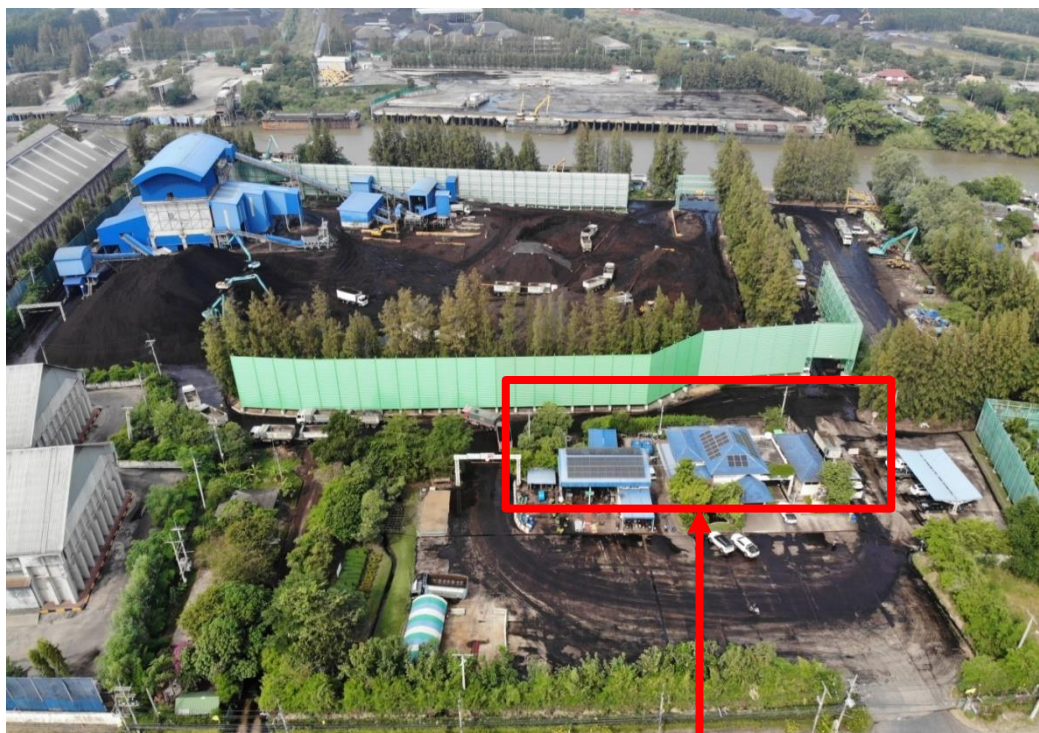
รูปภาพแสดงบริเวณที่ติดตั้งระบบโซล่าเซลล์ขนาด 24 kW ซึ่งตั้งอยู่บนหลังคาของอาคารสำนักงาน ที่ศูนย์จำหน่ายถ่านหินจังหวัดพระนครศรีอยุธยา
