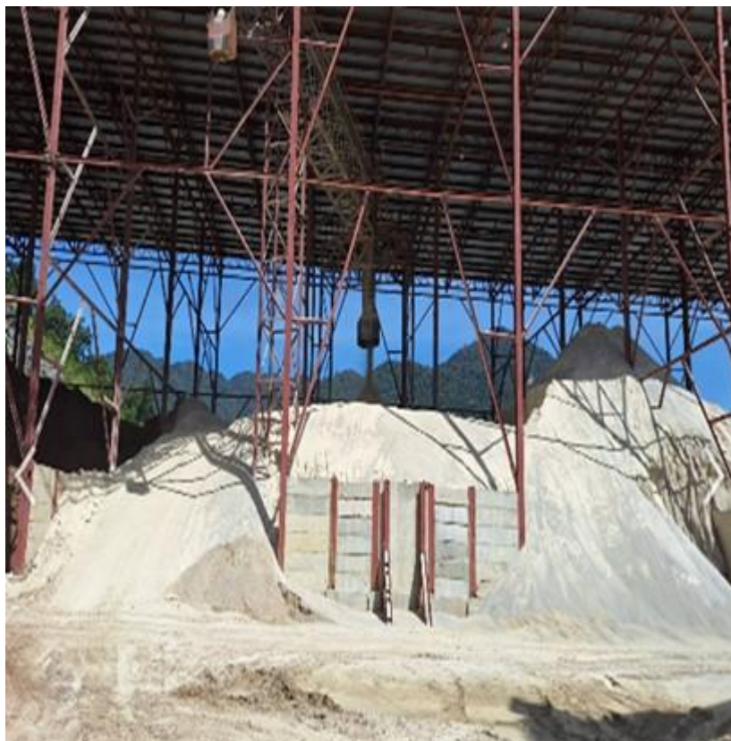
การใช้ฝุ่นหินจากโรงโม่ทดแทนทรายแม่น้ำส่วนหนึ่งในส่วนผสมคอนกรีต
