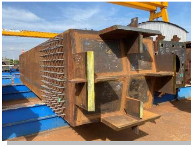
รูปตัวอย่างชิ้นงานขนาดใหญ่เหล็กเกรดพิเศษ ที่มีความหนา 60 มิลลิเมตร
