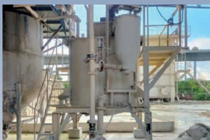
ระบบส่งกลับเศษตะกอนเปียกที่สายการผลิตกระเบื้องไฟเบอร์ซีเมนต์ สามารถลดเศษตะกอนทุกสายการผลิต
