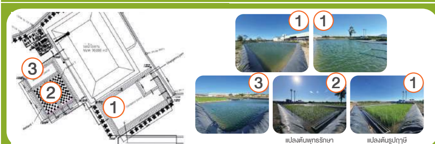
ปี 2568 "ตราเพชร" จัดทำโครงการระบบบำบัดน้ำจากกระบวนการผลิตแบบธรรมชาติ โดยใช้พืชบำบัดน้ำและตะกอนตามธรรมชาติ สามารถนำน้ำกลับมาใช้ใหม่ 100%
