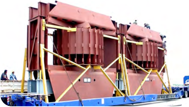
เสื้อพัดลม (Fan Casing)
