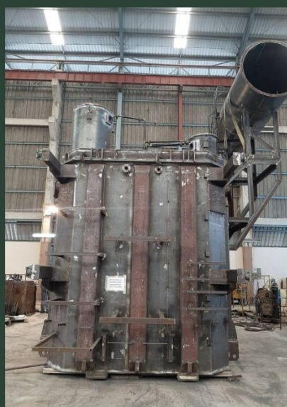
การทำตัวถังหม้อแปลงไฟฟ้า การผลิตตัวถังเตาอบหม้อแปลงไฟฟ้า
