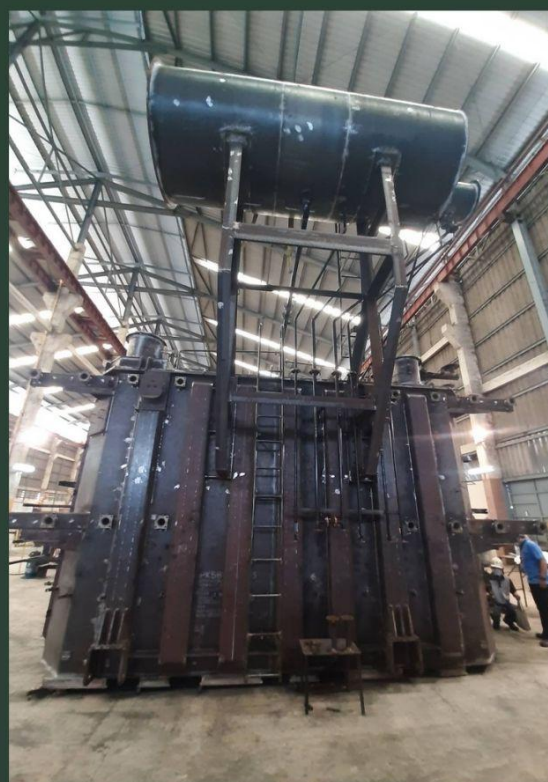
การทำตัวถังหม้อแปลงไฟฟ้า การผลิตตัวถังเตาอบหม้อแปลงไฟฟ้า
