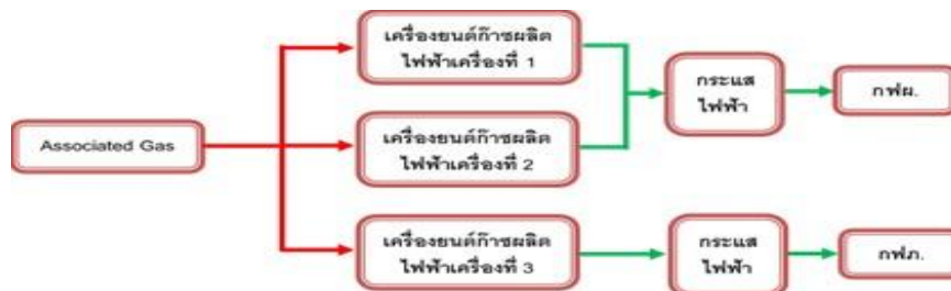
แผนผังแสดงภาพรวมของกระบวนการผลิตของโรงไฟฟ้าประจวบฯ-เอ
