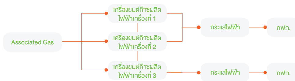
แผนผังแสดงภาพรวมของกระบวนการผลิตของโรงไฟฟ้าประดู่เฒ่า-เอ
