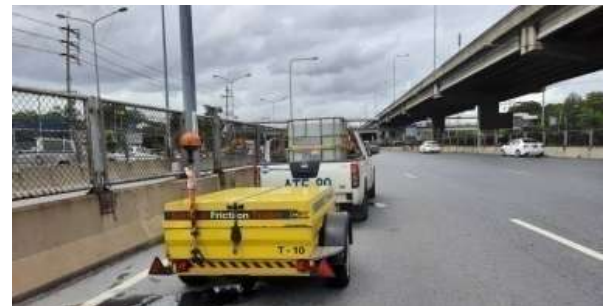
▲ การตรวจสอบความฝืดผิวทาง (International Friction Index: IFI) Skid Resistance Tester ด้วยวิธี Fixed Slip Method
