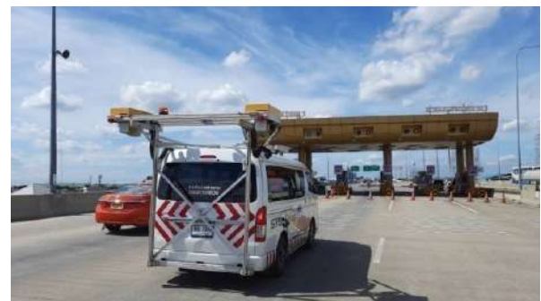
▲ การตรวจสอบผิวจราจร: ตรวจวัดค่าความขรุขระ (International Roughness Index: IRI) และร่อนล้อ
