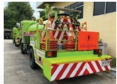
▲ งานลดความรุนแรงจากอุบัติเหตุ: อุปกรณ์ดูดซับแรงกระแทกหัวกระแทก (Crash Cushion) อุปกรณ์ดูดซับแรงกระแทกท้ายรถบรรทุก (Truck Mounted Attenuator)
