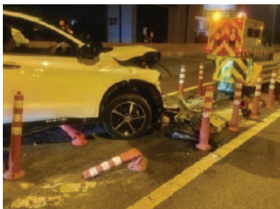
▲ งานลดความรุนแรงจากอุบัติเหตุ: อุปกรณ์ดูดซับแรงกระแทกหัวกระแทก (Crash Cushion) อุปกรณ์ดูดซับแรงกระแทกท้ายรถบรรทุก (Truck Mounted Attenuator)
