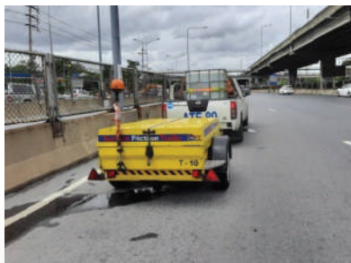
▲ งานลดความรุนแรงจากอุบัติเหตุ: อุปกรณ์ดูดซับแรงกระแทกหัวกระแทก (Crash Cushion) อุปกรณ์ดูดซับแรงกระแทกท้ายรถบรรทุก (Truck Mounted Attenuator)
