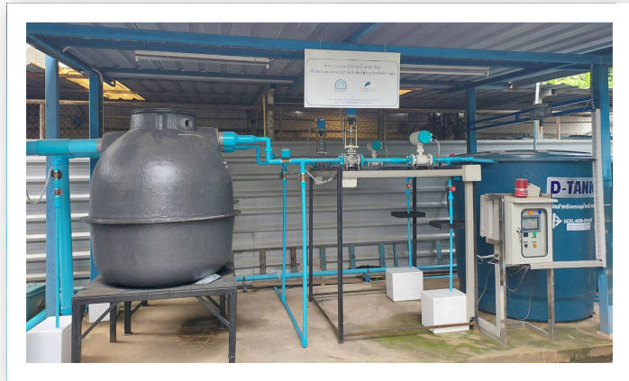
สถานที่ทดสอบถังบำบัดน้ำเสียโครงการฉลากถังบำบัดประสิทธิภาพสูง
