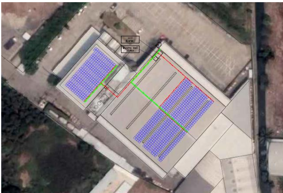
รูปแสดงแบบการติดตั้งแผงโซล่าเซลล์
