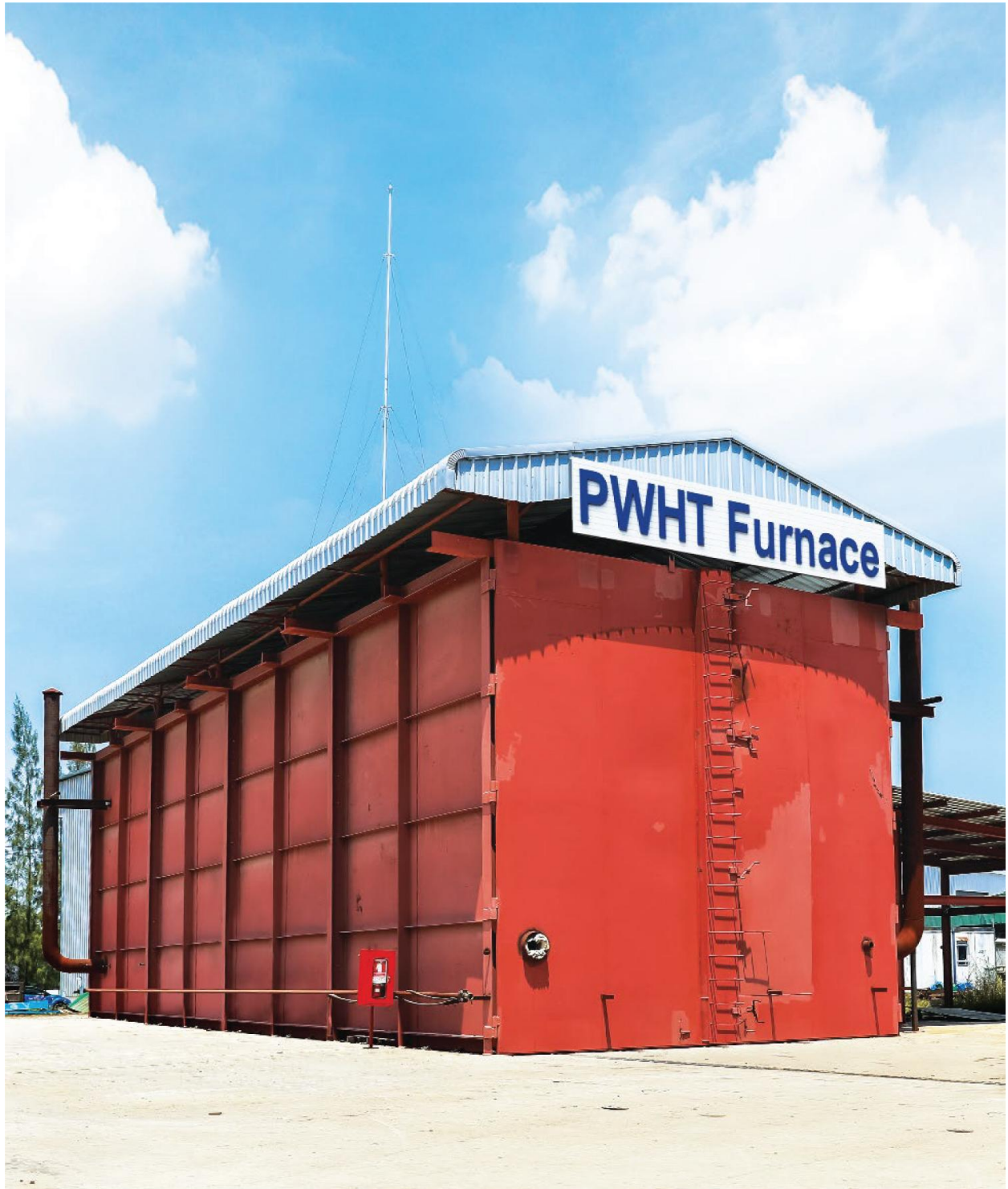
อุปกรณ์ให้ความร้อนภายหลังการเชื่อม
